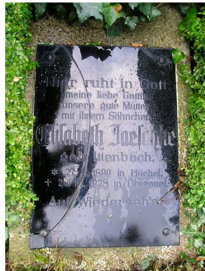
Durch zu stark angezogene Befestigungen zerbrochene Inschriftplatte aus schwarzem Glas. Hennef-Bödingen, 2006
