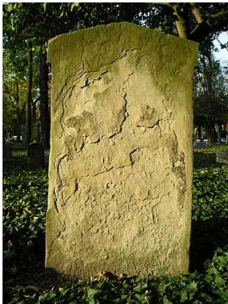
Mehrlagige Schalenbildung an einem Sandstein. Köln, Geusenfriedhof, 2009
