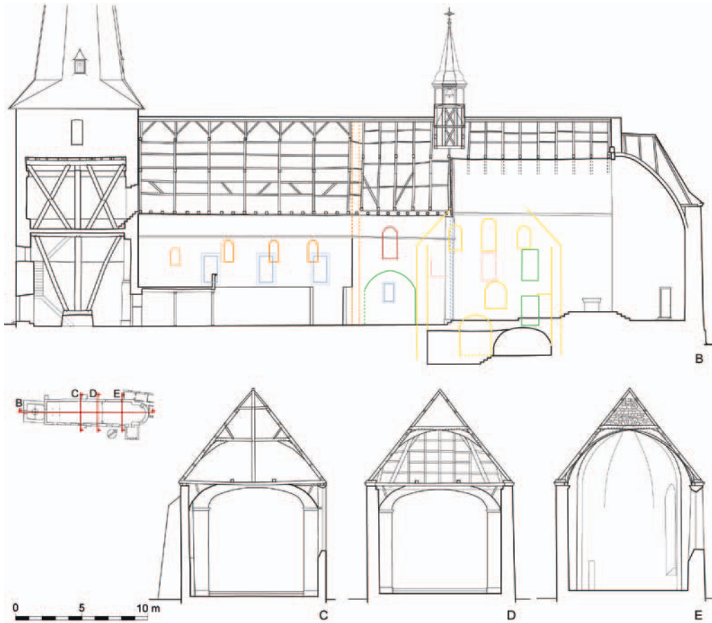
20. Längsschnitt B, Blick nach Norden, maßstäbliche Projektion der Baubefunde, Querschnitte C: Pfarrkirche, Schnitt vor ehem. Trennwand, D: Nonnenkirche, Blick auf Fachwerkwand (1730 d), E: Nonnenkirche, Schnitt vor Apsisbogen mit Holztonnengebinde (1448 d). Vermessung: Hans Meyer; Zeichnung: Kristin Dohmen, Christina Notarius, LVR-ADR.
