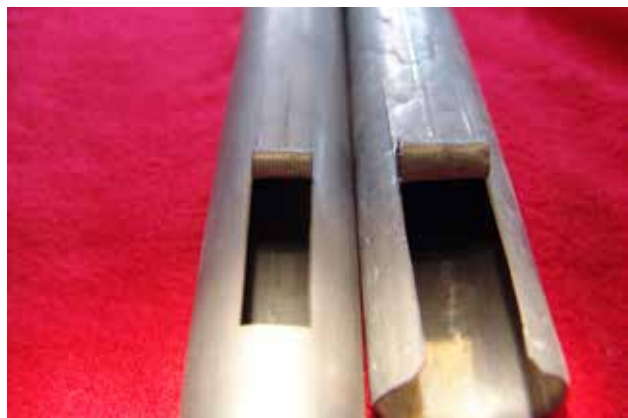
7. Vergleich unterschiedlicher Stimmeinrichtungen/ Pfeifenmündungen: links Expression mit Stimmrolle/rechts Stimmrolle. Foto: Manfred Schwartz, Much.
