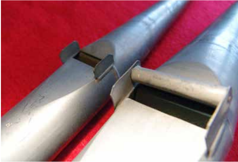
6. Beispiele für Bartformen: links Seitenbärte/rechts Rollenbart. Foto: Manfred Schwartz, Much.
