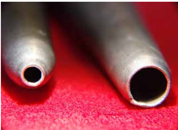
5. Vergleich unterschiedlicher Fußlochweite: links gekulpt/rechts offener Fuß. Foto: Manfred Schwartz, Much.
