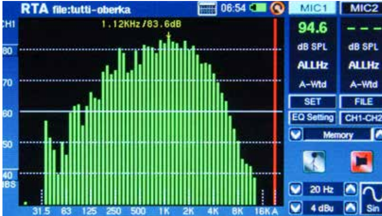
10. RTA-Messung, mittig im Raum: Düssel-dorf, Oberkassel. Sauer-Orgel, 2004 65/III/P – Generaltutti. Messung/Dokumentation: Manfred Schwartz, Much.
